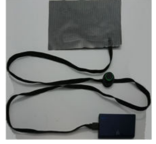
1枚ヒーターシートのユニット例
